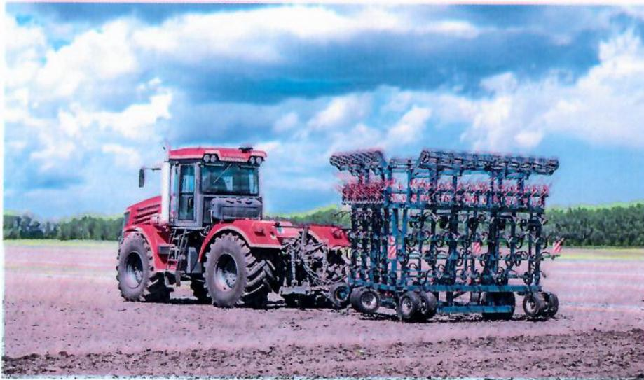
**К**ультивация почвы – одна из ключевых и самых распространенных агротехнологических операций. Культиваторы позволяют провести предпосевную подготовку почвы, уничтожить или подрезать сорную растительность, выровнять поверхность поля, разрыхлить почву и измельчить крупные комья земли, равномерно распределить по поверхности поля крупные пожнивных остатки.
