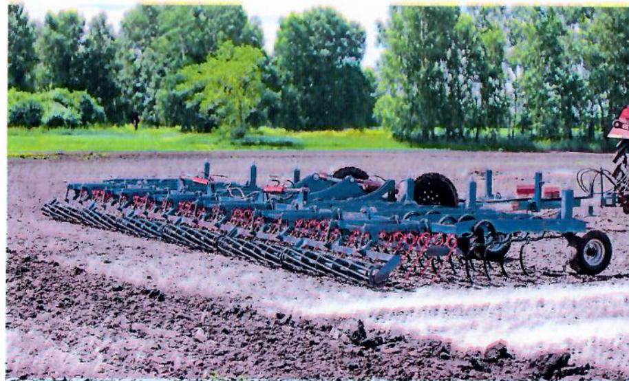
остатками и сорной растительностью. В конструкции исключены модульные рамки, стойки закреплены непосредственно на раму культиватора. Это позволило уменьшить его массу, что снижает затраты на ГСМ.
